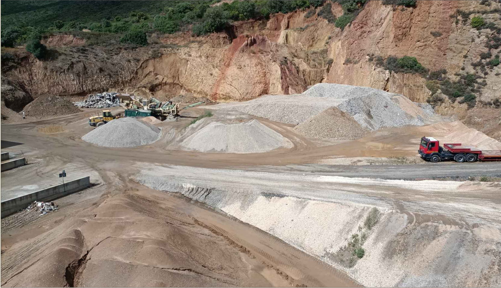
2 impianto di recupero - gruppo di frantumazione e cumuli mps
